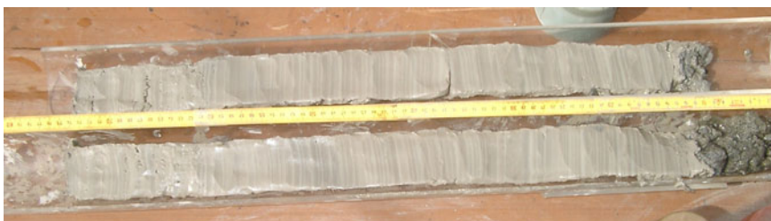
Figur 12 Foto på sedimentkärna 8 i Lilla viken som är tagen från liten båt med Livingstoneprovtagare.
