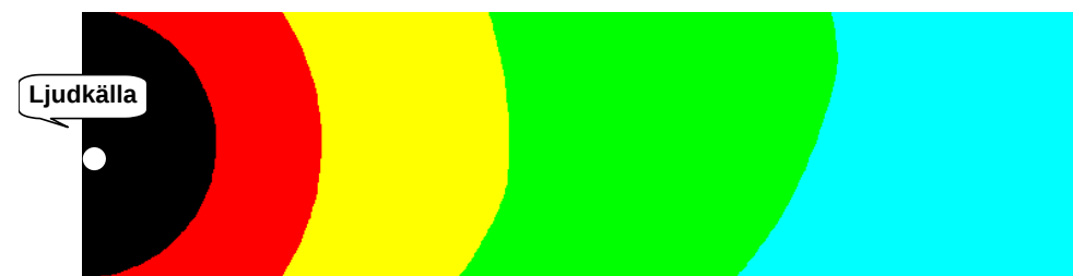
Ljudutbredning från högt liggande källa (ex skorsten) över mjuk mark - markdämpning minskar
