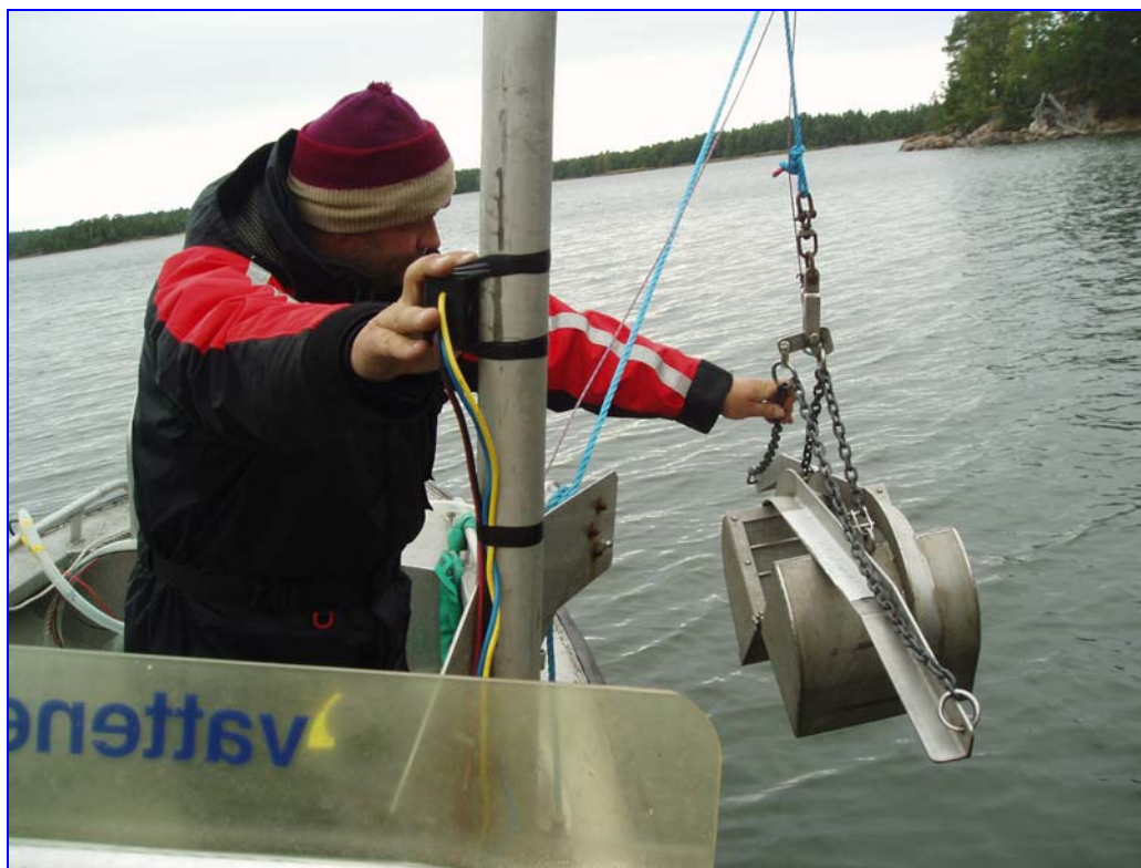
Figur 3-1. Van-Veenhuggare med kran användes för kvantitativ provtagning vid mjukbottenlokalerna.
